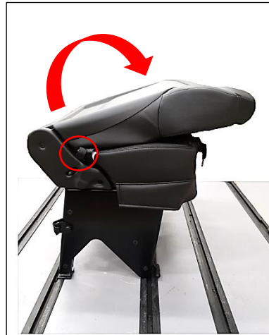
Työnnä istuimen selkänojaa voimakkaasti alaspäin ja va- pauta säätölenkki
