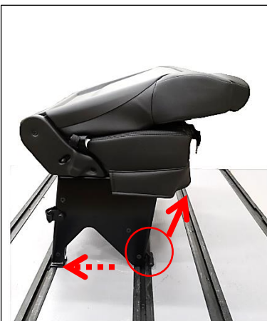
Vapauta jalusta lattiakiskosta nostamalla sisemmästä vivusta ylöspäin. Työnnä jalustaa hie- man taaksepäin helpottaaksesi jalustan irrotusta lattiakiskosta.
